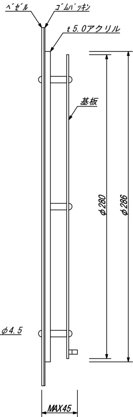
DC電源使用時外径寸法
